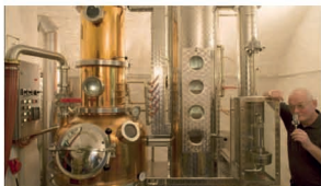
Die Verarbeitungsart ist vor allem die Destillation in einer zwar kleinen, aber technologisch hochmodernen Anlage, die gegenwärtig auf die Verarbeitung von etwa 60 t Obst ausgelegt ist. In der Brennerei in Dresden-Klotzsche hängen die Urkunden von 20 Medaillen aus nur einem Jahr (von insgesamt 73 Medaillen).
